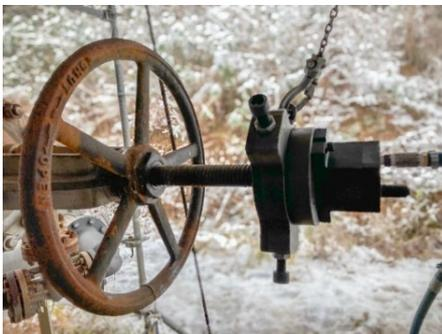
シリカスケール、カルシウム系スケール、硫化物スケール、ケイ酸塩スケールなどの付着により、多くの地熱発電所では、配管の閉塞やバルブの固着が発生します。
